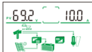
3) PV-interface (Display PV-spanning en PV-stroom)
